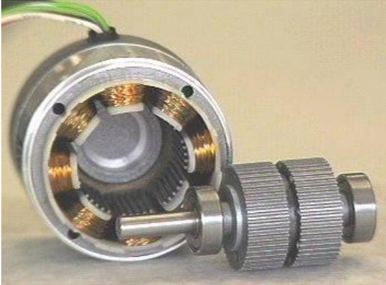
Il funzionamento avviene alimentando le due fasi in successione, con l'inversione della corrente della stessa fase ogni due scatti. Si ottiene così un movimento a passi dovuto all'azione combinata della coppia prodotta dall'eccitazione statorica, di quella di riluttanza e della coppia prodotta dal magnete rotorico, con un angolo di passo pari a:
