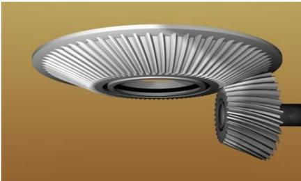
La struttura realizzata è chiamata pignone-corona (dove per corona si intende l'ingranaggio posto orizzontalmente, mentre per pignone quello posto verticalmente). Rispetto alla figura analizzata, nel robot sono presenti due corone (una comandata dal motore 4 ed una comandata dal motore 5), poste parallelamente l'una rispetto all'altra, posizionate ai due estremi del diametro esterno del pignone, come nella figura sottostante.
