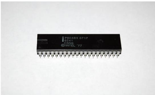
Nella foto il primo microcontrollore prodotto: l' 8048 di Intel, rilasciato nel 1975, con RAM e ROM sullo stesso chip. Questo componente è stato utilizzato in più di un miliardo di tastiere per PC e numerose altre applicazioni.
